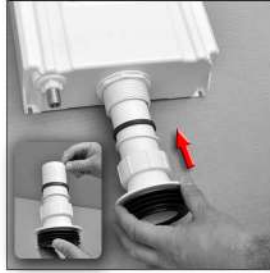
2 Boşaltma grubu adaptörü üzerine Adaptör contası, Sıkıştırma somunu, Sıkıştırma ringi ve conta eklenerek Tank ile montajlanır.
