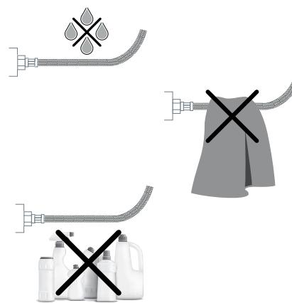
• Après avoir raccordé la robinetterie à l'installation, ouvrir la vanne et observer s'il y a des fuites au niveau les points de raccordement. S'il y a une fuite aux points de raccordement, effectuer un montage approprié pour l'étanchéité du raccordement.
