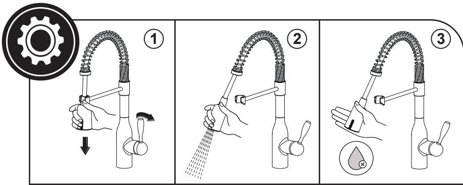
**TR** Eliniz yan sensör üzerinde tuttuğunda su akışı başlar ve tuttuğunuz süre boyunca su akışı devam eder. Elinizin sensörden çektilen 2 saniye sonra su otomatik kapanacaktır.
